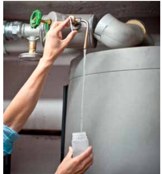
5. Entnahme einer Trinkwasserprobe zur Analyse im Labor
