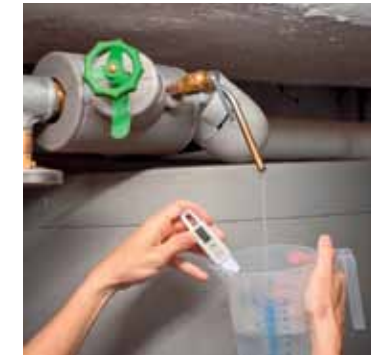
4. Temperaturmessung in 250 ml Wasser nach Probenahme sowie Dokumentation
