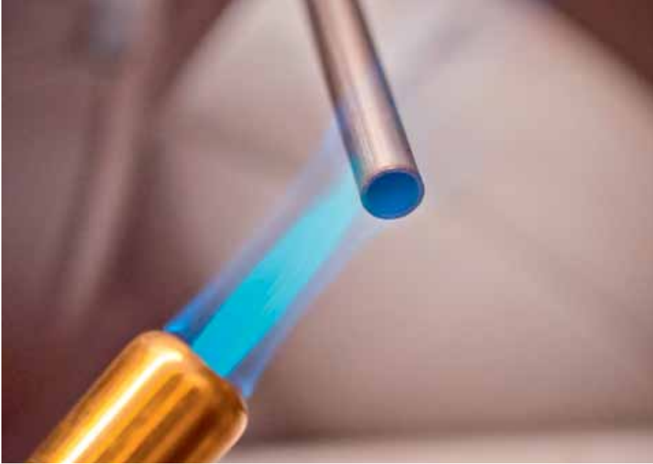
1. Abflammen des Probenahmeventils zur Desinfektion
